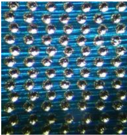
а) Q-switch лазер: нерегулярная последовательность импульсов.
