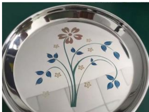
Рисунок 9 - Цветная маркировка на нержавеющей стали
