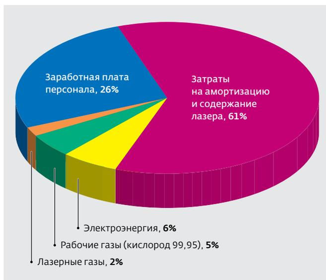
**Рис.6.** Структура затрат при лазерной резке низкоуглеродистых низколегированных сталей
