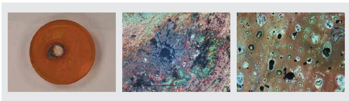
**Рис.2.** Поврежденная оптика лазерного резонатора
