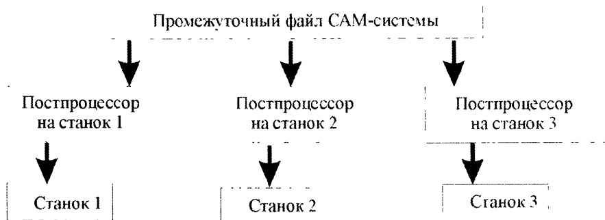
Рис. 12.28. Схема получения УП для конкретного комплекса “Станок - система ЧПУ”.
