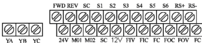
4-2-2 Расположение управляющих клемм (0,4~315кВт)
