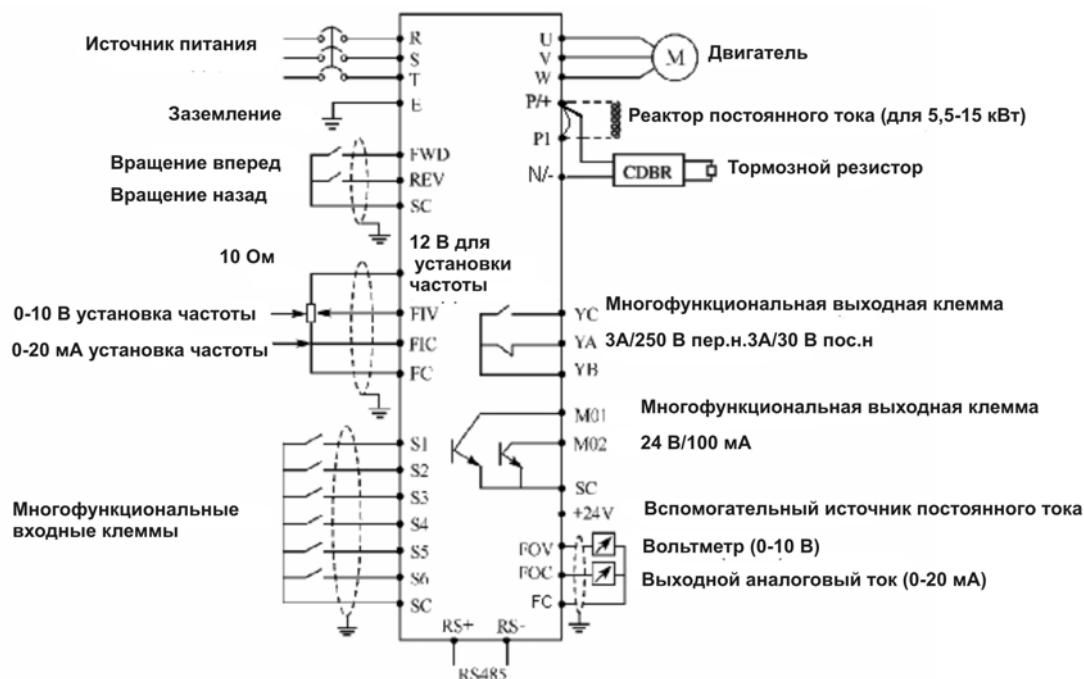
4-2-2 Расположение управляющих клемм (0,4~315кВт)
